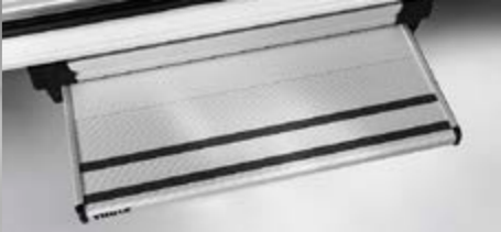
7 Einstiegsstufe mit elektr. Ausfahrfunktion
